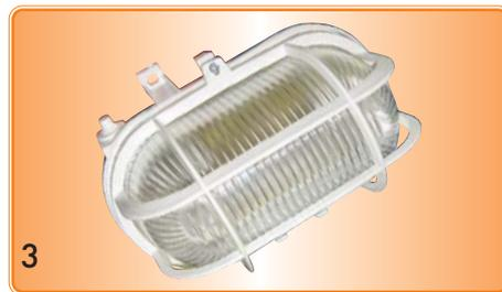
Светильники "Раунд" отличаются удобством обслуживания. Рассеиватель светильника имеет специальные выступы, позволяющие легко снимать стекло, повернув его против часовой стрелки, открыв тем самым доступ к лампе. Светильник имеет высокую степень защиты IP 44. Полипропиленовый корпус позволяет повысить влагостойкость светильника, облегчить его вес. Светильник "Раунд 1" поставляется в комплекте с гермоводом.
