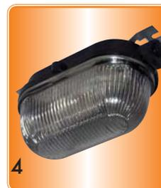
Светильники применяются для освещения влажных, сырых, пыльных, пожароопасных производственных помещений. Обладают высокой степенью защиты от пыли и влаги IP-53. Корпус изготавливается из карболита. В светильниках могут применяться как обычные лампы накаливания ЛОН, так и компактные люминесцентные лампы КЛЛ. В светильниках установлены керамические патроны с цоколем E 27. Светильники выпускаются согласно ТУ 3461-005-35936301 в соответствии с ГОСТ Р МЭК 60598-1-2003, ГОСТ Р МЭК 598-2-1-97
