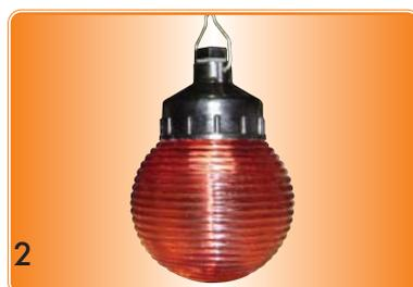
Светильники применяются для освещения объектов проведения ремонтно-строительных работ. Обладают высокой степенью защищенности от пыли и влаги IP-53. Корпус изготавливается из карболита. В светильниках применяются лампы накаливания ЛОН. В светильниках установлены керамические патроны с цоколем E 27.
