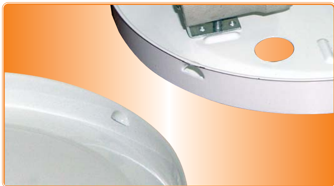
Благодаря наличию просечек на корпусе светильника стекло надежно фиксируется на основании всего одним винтом, что максимально облегчает обслуживание светильника подобной конструкции
