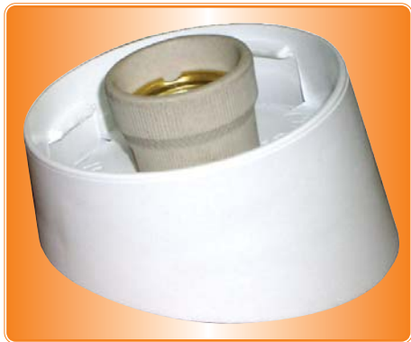
Основание наклонное для светильника НББ 64-60-080 Материал: пластик Цоколь параметры/материал: Е 27/керамика Размер основания: задняя стенка 96х100, высота 54 мм
